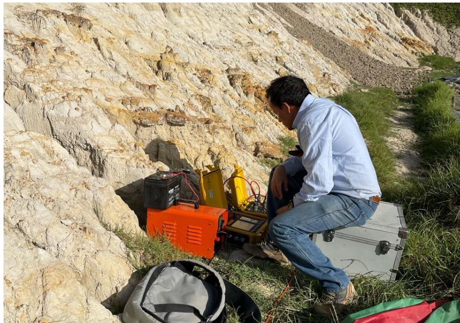
Figura 5-2. Fotografía Adquisición / Tomografías eléctricas – Parque tecnológico y ambiental de Pírgua Fuente: INGEOMAD SAS.
