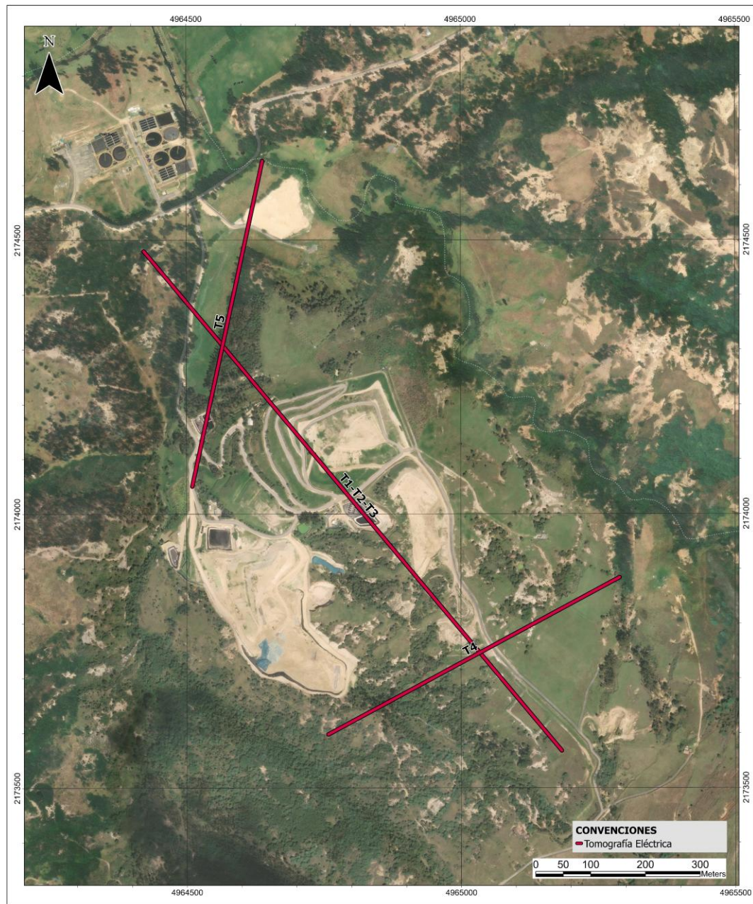
Figura 5-1. Malla de adquisición Tomografías Eléctricas Fuente: INGEOMAD SAS.
