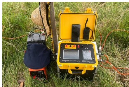
Figura 5-4. Equipo utilizado para la adquisición de tomografías eléctricas Fuente: INGEOMAD SAS. 2025.
